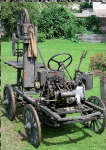
Fahrbare Bandsäge mit Austro Daimler Motor
